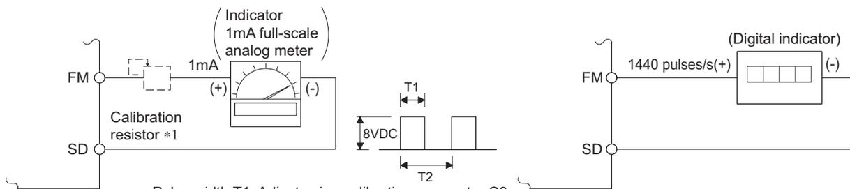
Pulse width T1: Adjust using calibration parameter C0
